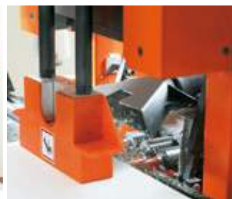
Торцевое сверление (возможно только с PRO-CENTER)
