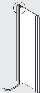
Установите кабель в несущий профиль
