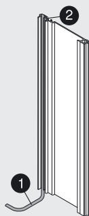
Несущий профиль с обоими кабелями
