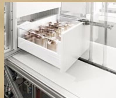
**ИСПЫТАНИЕ ЯЩИКОВ С НАГРУЗКОЙ**
