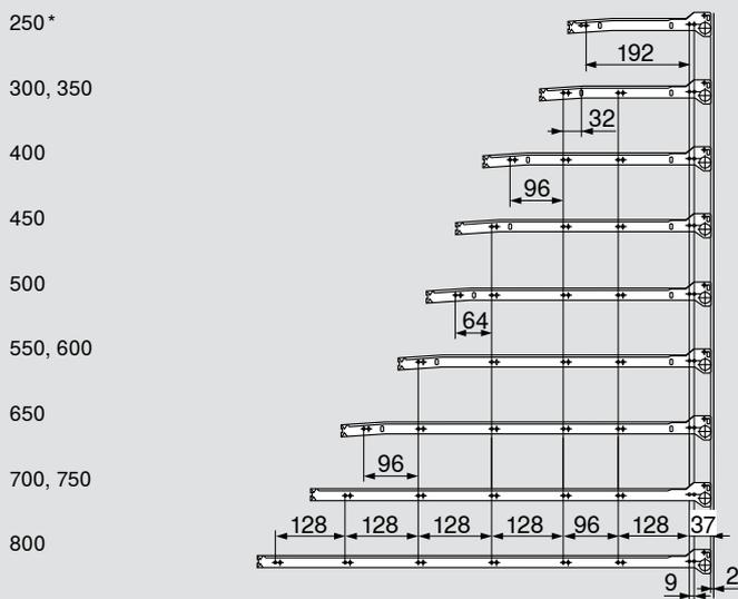
Мин. внутр. глубина корпуса = NL + 3 мм
